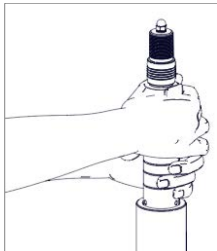
Abb. 5-17 Handhaltung bei Beschussprüfung
