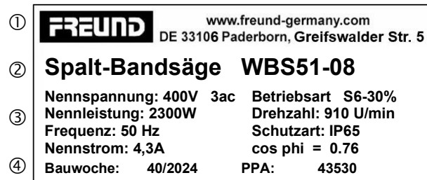
Fig. 3-11 Ejemplo de placa de características
