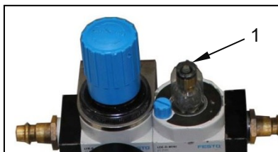
Рис. Заполнение пневмоблока
