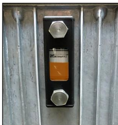
Рис. Оптимальный уровень заполнения масла
