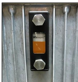
Рис. 8-1 Оптимальный уровень заполнения масла
