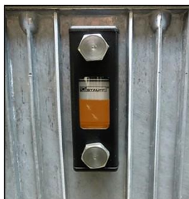
Fig. niveau de remplissage d'huile optimal
