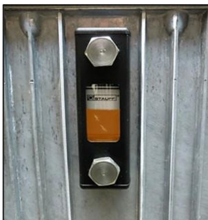
Fig. 5-1 Niveau de remplissage d'huile optimal
