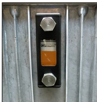
Fig. Nivel óptimo de aceite
