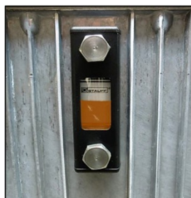
Ilust. 8-1 Nivel de llenado de aceite óptimo
