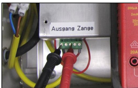
Рис. 9-6 Измерение напряжения через голову
