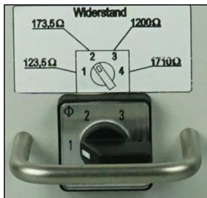
Рис. 6-5 Поворотный выключатель для выбора тестового сопротивления STUN-CHECK-M
