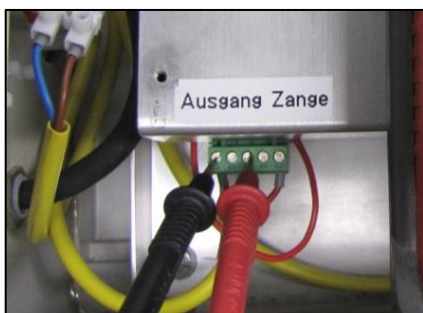
Рис. 9-4 Измерение напряжения через голову E6 и E8
