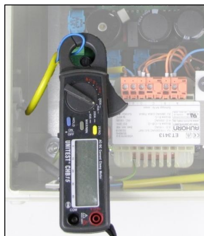
Рис. 9-2 Измерение силы тока при оглушении E4
