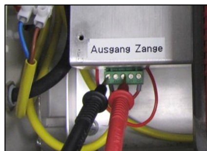
Fig. 9-3 Måling av hodebedøvingspenning E6 og E8
