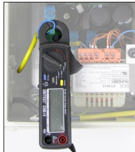
Fig. 9-2 - Misurazione dell'ampereaggio di stordimento E4
