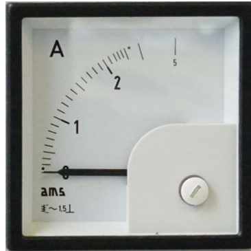
Fig. 5-5 - Indicazione dei volt con vite di regolazione in basso a destra
