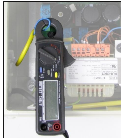
Abb. 9-2 Mesure de l'intensité du courant d'étourdissement E4
