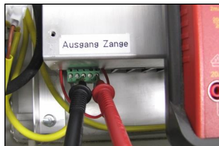
Fig. 9-6 Mesure de la tension d'étourdissement cardiaque
