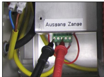
Fig. 9-4 Mesure de la tension d'étourdissement cérébral E6 et E8
