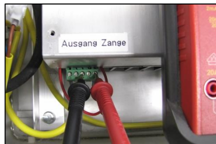
Imag. 9-5 Medición de la tensión de aturdimiento del corazón
