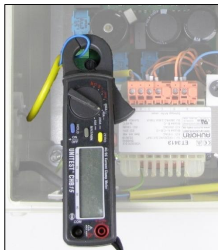
Imag. 9-2 Medición de la intensidad de corriente de aturdimiento E4
