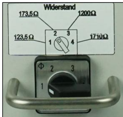
Fig. 6-5 Interruptor giratorio para resistencia de prueba STUN-CHECK-M
