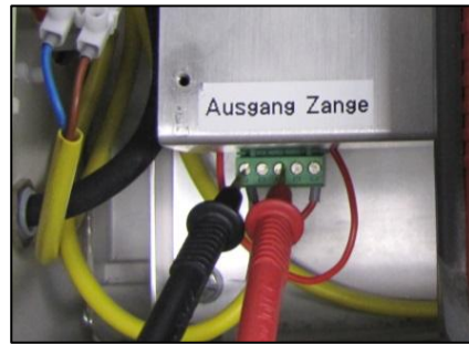
Imag. 9-3 Medición de la tensión de aturdimiento del cabezal E6 y E8
