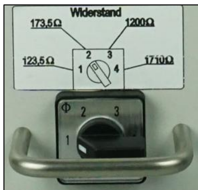
Afb. 6-5 Drejekontakt testmodstande STUN-CHECK-M
