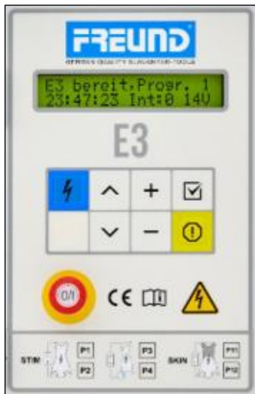
Abb. 3-13 Anzeige- & Bedienelemente STIM-E3
