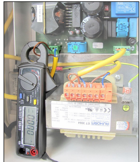
Afb. 8-4 Meting van de bedwelmingsstroomsterkte
