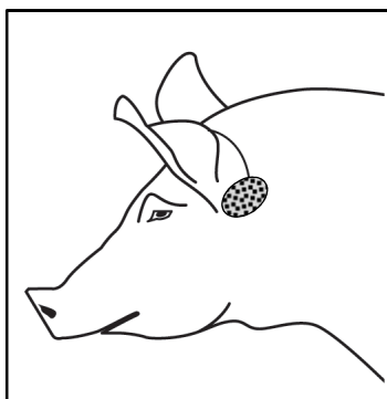
Afb. 6-1 Ideale positionering van de elektroden (zij- en vooraanzicht)
