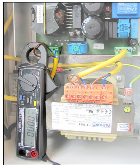
Fig. 8-4 Mesure de l'intensité de courant d'étourdissement
