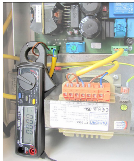
Imag. 8-4 Medición de la intensidad de corriente de aturdimiento
