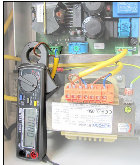
Abb. 8-4 Messung der Betäubungsstromstärke
