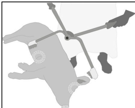
Abb. 6-4 Ideale Ansetzpositionen der Elektroden
